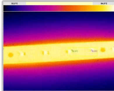
Термограмма, модуль NEO-L-18LS2835-280 ток 350 мА,  $T_a = 25^\circ\text{C}$ , установившийся тепловой режим, без радиатора.
